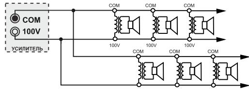
мощности 5W - белый или 10W - красный. Суммарная мощность всех громкоговорителей в системе не должна превышать заявленную мощность усилителя (рекомендуем оставлять запас по мощности 20%). На трансляционном усилителе приходящий кабель должен подключаться к выходным клеммам COM(-) и 100V(+). Следите за соблюдением полярности подключения. Низкоомного подключения в WPA10T нет.
